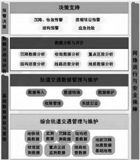
图 1 轨道交通预警系统数据管理图
