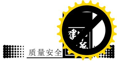
学来测定肼的体系，用大于五倍的酸性甲醛的化学发光反应来测定空气中的甲醛含量。
